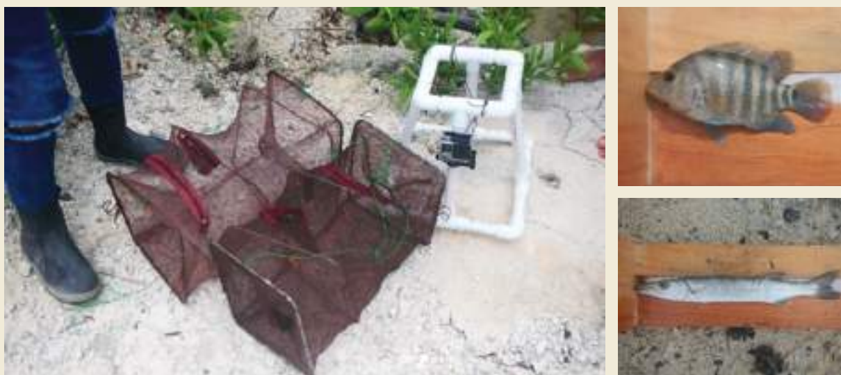
Figura 2.29 – Trampas y soporte para cámaras utilizadas para colecta y toma de videos de peces en los canales de manglar. Fotos de Daniel Arceo.
