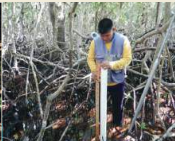
Colocación de sensor de presión automático en sitio conservado de referencia
